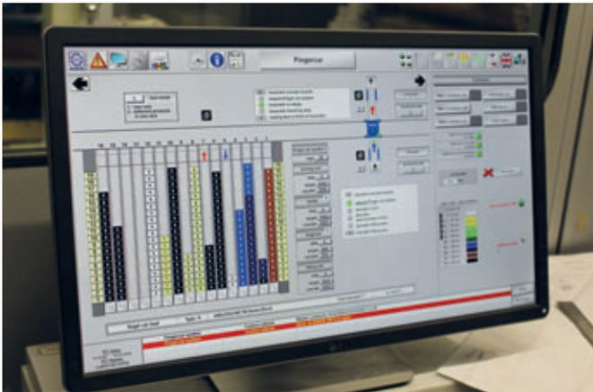
Estación de mando de la nueva instalación de bloques de hormigón, desde la cual se pueden controlar todos los parámetros importantes. Entre otros, por ejemplo la gestión de almacenamiento de la cámara de curado.
