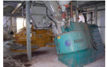
Una mezcladora Haarup y una Eirich suministran hormigón monocapa y bicapa a la máquina de producción de bloques de hormigón.
