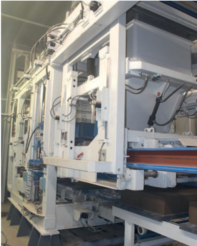
La máquina de producción de bloques de hormigón tipo KRS 4 de Rekers ...
