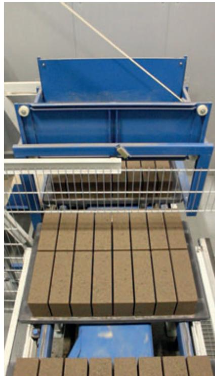
Las bandejas con los productos de hormigón frescos son llevadas mediante cintas transportadoras al ascensor que se encuentra en la cámara de curado.
