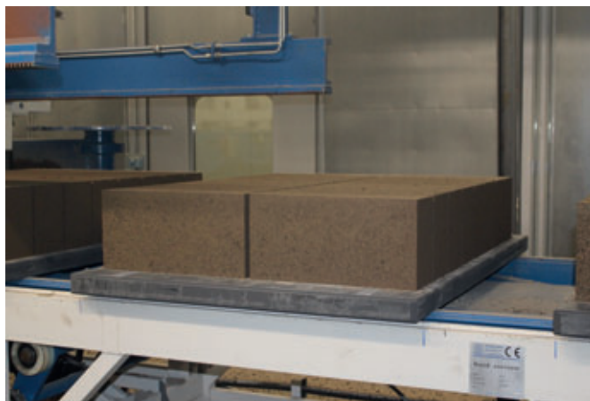
As placas de base da Wasa asseguram uma estabilidade e capacidade de carga suficientes para o transporte de produtos de concreto.
