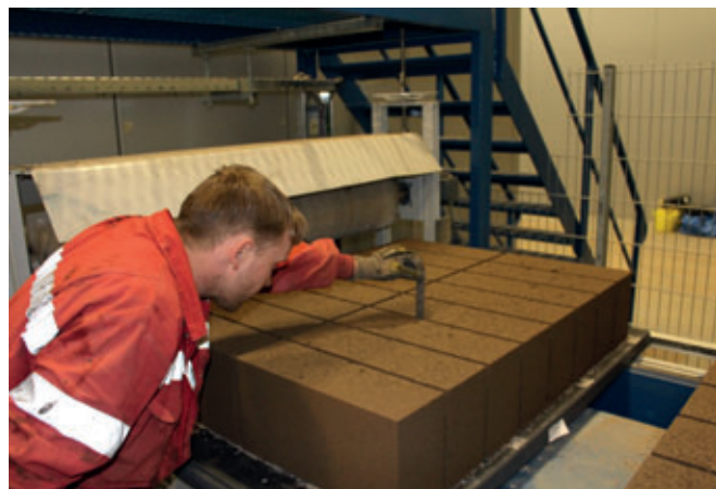
Controle de qualidade de amostras aleatórias antes da armazenagem na câmara de cura.
