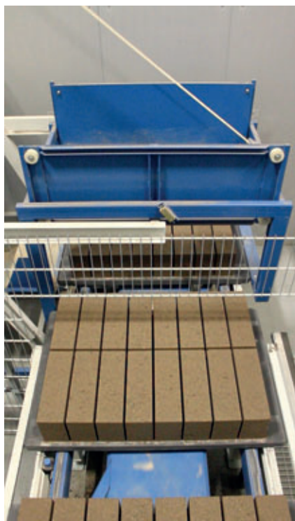
As placas de base com os produtos de concreto frescos são recolhidas através de esteiras transportadoras para o elevador que se encontra na câmara de cura.
