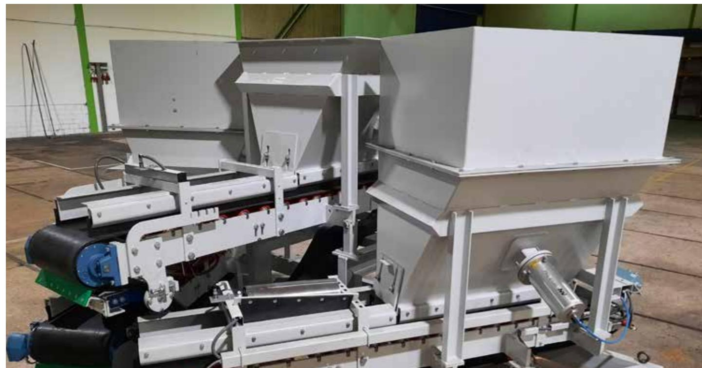
REKERS Sistema de mistura de cores Embora REKERS não seja o inventor de produtos de concreto com uma mistura de superfícies de cores diferentes, ele foi o primeiro a desenvolver um sistema que pode produzir tais superfícies com alta reprodutibilidade em máquinas de moldagem de blocos na prática.
