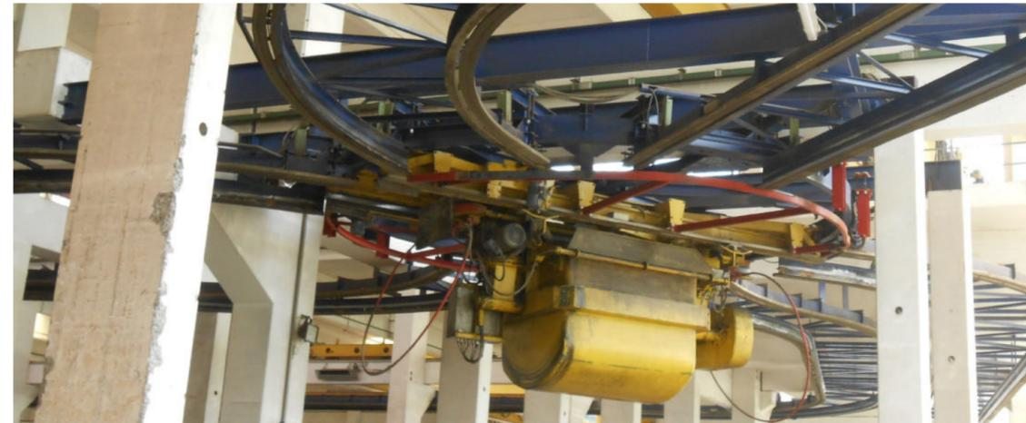
Aufgrund einer großen Variabilität unterschiedlicher Doppelfahrschienen mit verschiedenen Möglichkeiten von Kurven und Steigungen, lässt sich die Streckenführung in hohem Maße an örtliche Gebäudebedingungen anpassen.
