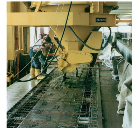
Выгрузка из распределителя бетона может осуществляться различными способами в зависимости от типа бетона или материала.
