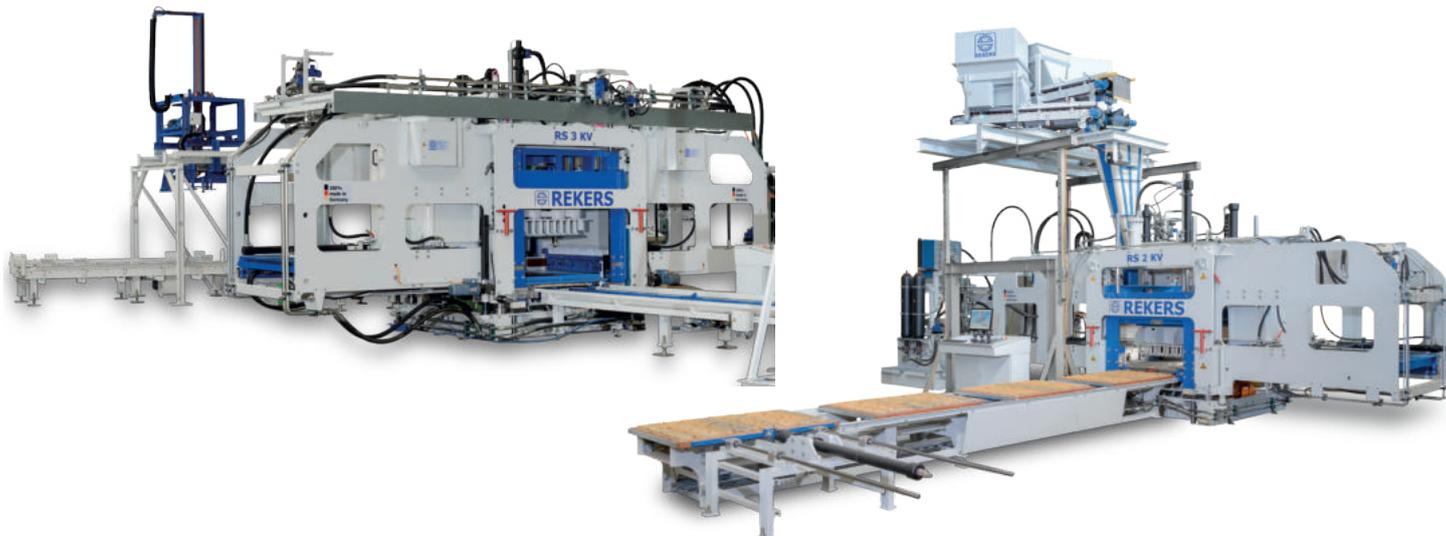
Wie die Steinformmaschine RS 1 sind auch die Steinformmaschinen RS 2 und RS 3 mit hydraulischem Antrieb der Füllwagen konzipiert. Jedoch nicht, wie bei traditionellen Maschinen, mittels Schwingen, sondern mittels direkt wirkender hydraulischer Zylinder. Alle Hauptbewegungen werden mittels Proportionalventiltechnik angesteuert und mithilfe absoluter Linearmesswertgeber überwacht.
