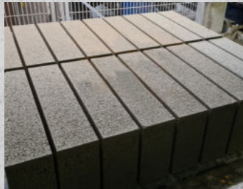
Dichte 1.300 kg/m³ – Druckfestigkeit 12 N/mm² Удельная масса 1.300 кг/м³ – прочность на сжатие 12 N/mm²
