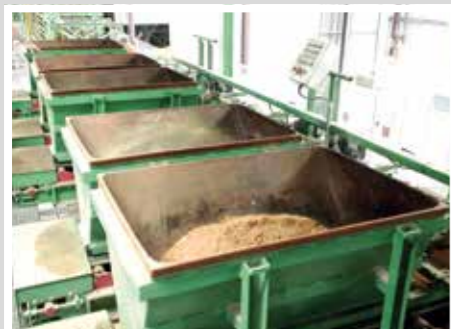
Detail: Vorsatzbunker „Kobaflex“ beschichtet
