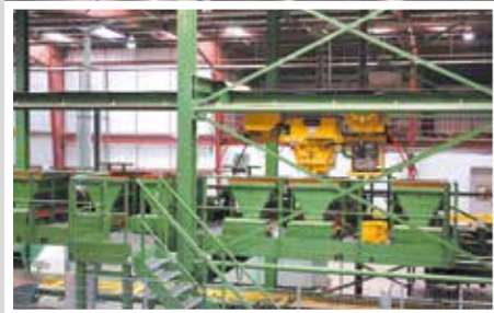
Colourblend-Vorsatzbunker bis zu 6 Farben, Beschickung über Kübel
