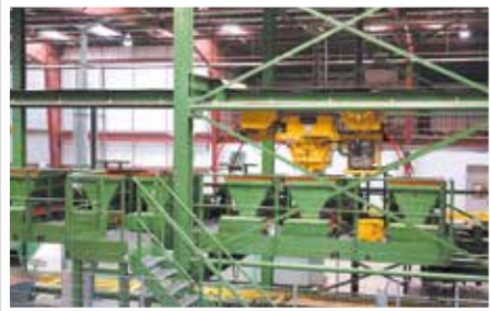
Colourblend-Vorsatzbunker bis zu 6 Farben, Beschickung über Kübel
