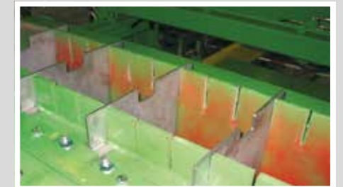
Bunker mit Trennwänden Бункер с разделительными стенками
