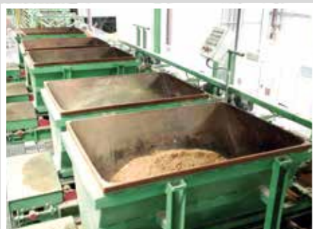
Detail: Vorsatzbunker „Kobaflex“ beschichtet
