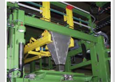
Auslauf Schwenkband Загрузка через поворотный конвейер
