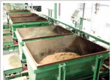
Detalle: Tolva con revestimiento de „Kobaflex“
