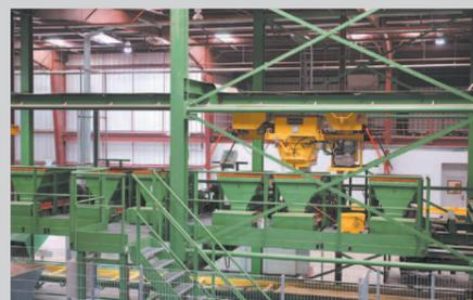
Colourblend-Vorsatzbunker bis zu 6 Farben, Beschickung über Kübel
