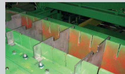
Bunker mit Trennwänden
