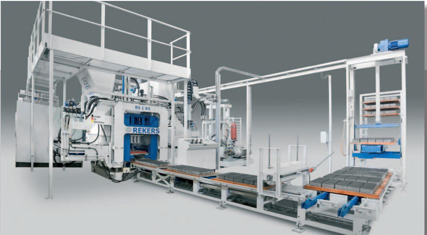
Die Nassseite ist als modulares System aufgebaut, welches somit an die Bedürfnisse des Kunden angepasst werden kann und somit auch modular erweiterbar ist.
