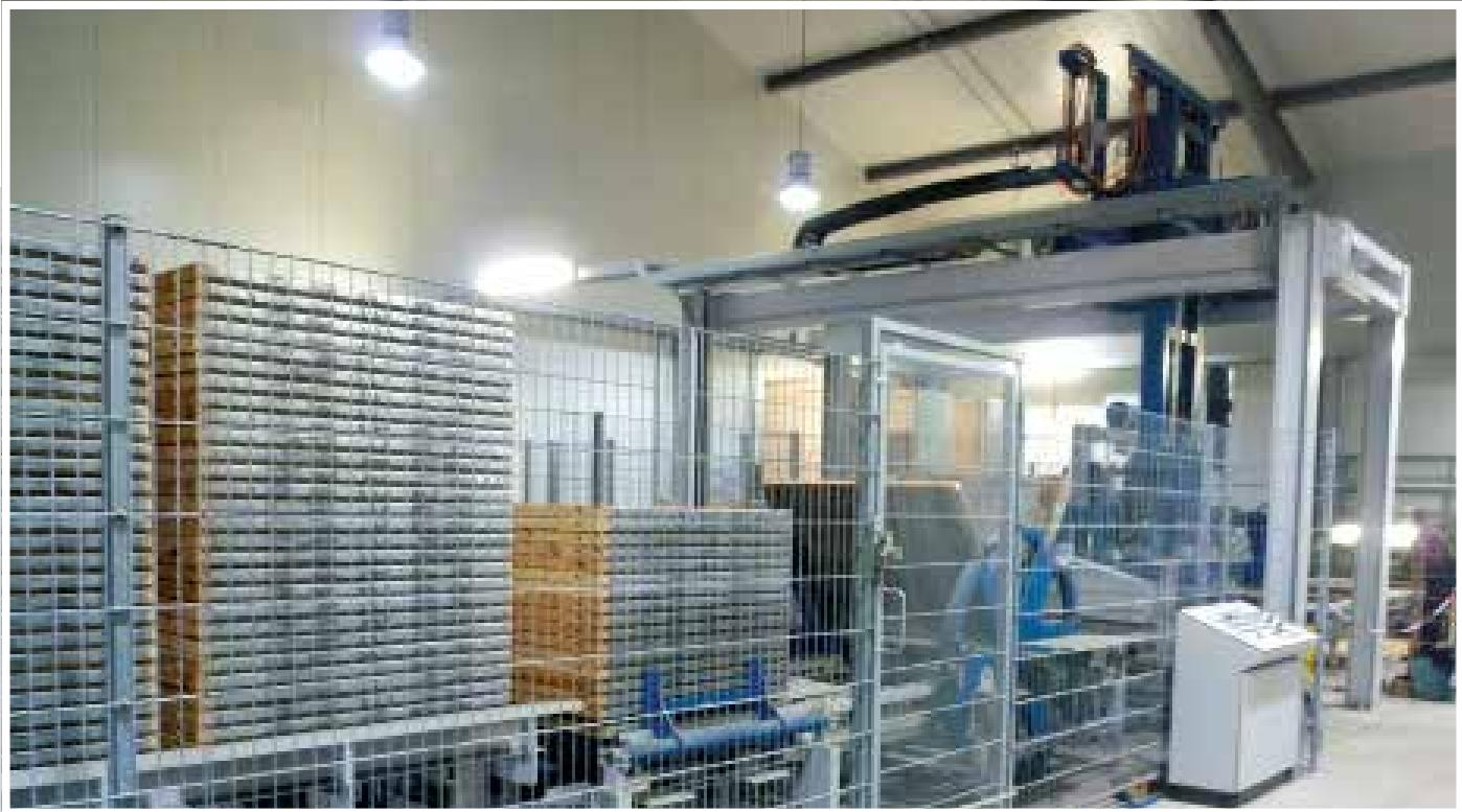
Für das reibungslose Zusammenspiel von Paketierung und Produktion ist ein leistungsfähiges Palettenhandling erforderlich. Dies beinhaltet ein gründliches Reinigen, ein schonendes Wenden, ein sicheres Stapeln und Vereinzeln sowie ein flexibles Zwischenlagern. Das vollautomatische REKERS-Palettenhandling bietet alles!
