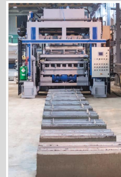
Die Kippformmaschine RK1 ist eine automatische Vibrationsmaschine für die Produktion von speziellen, großen Produkten aus verdichtetem Beton.
