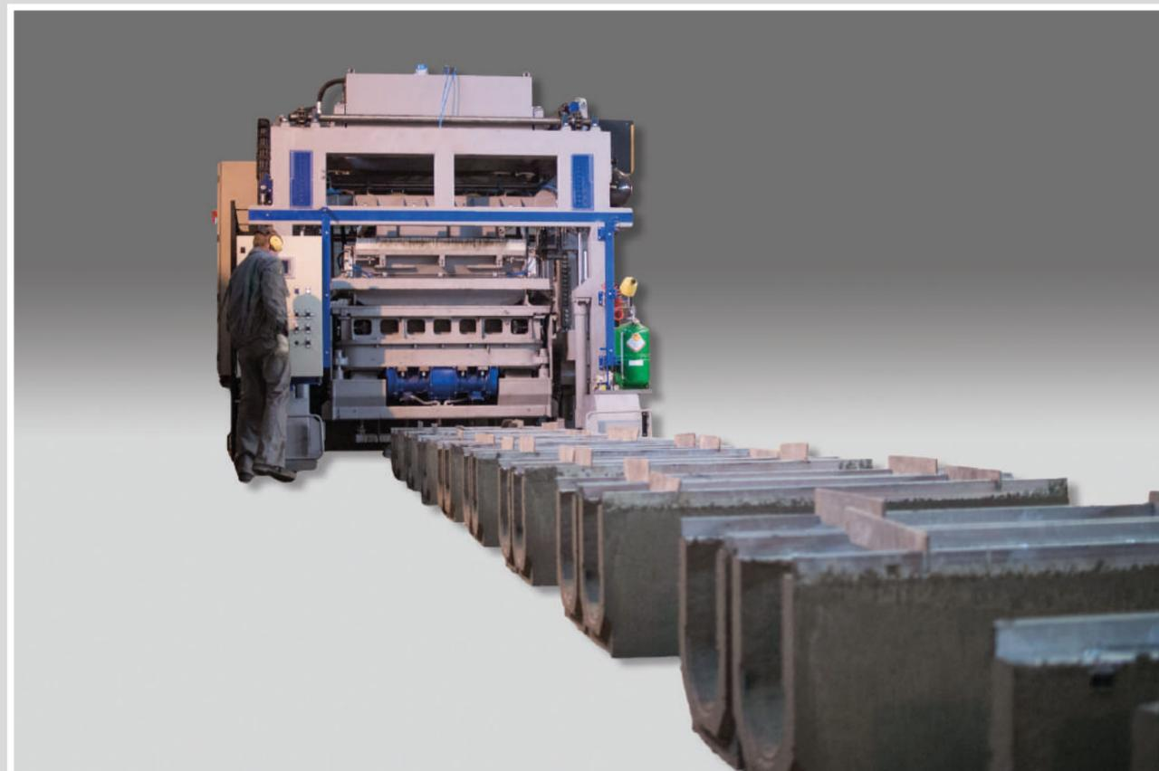
*Машина напочвенного формования RK1 автоматический вибропресс для производства специальных крупных изделий из уплотнённого бетона.*
