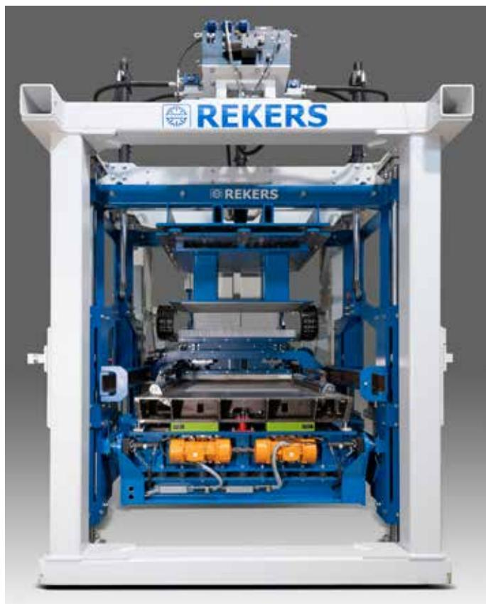
Se logra un proceso de llenado optimizado mediante un carro de llenado autoportante con una rejilla de agitación accionada hidráulicamente, que se puede ajustar en términos de frecuencia de agitación y carrera.
