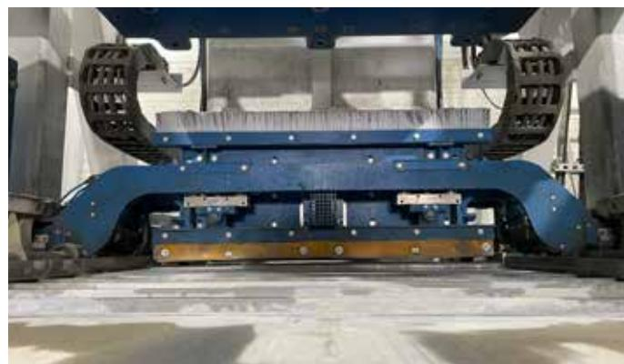
Os produtos verdes acabados são desmoldados em um palete que é fixado no molde ou estrutura vibratória antes do processo de despejo. Como resultado, os danos ao produto durante a desmoldagem são amplamente descartados. Também única é a cinemática do movimento de inclinação por meio de um motor elétrico controlado por frequência, que não apenas permite movimentos suaves, mas também funciona com muito mais eficiência energética do que os acionamentos hidráulicos convencionais.
