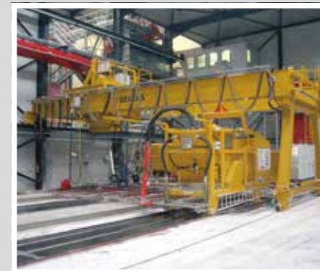
TTT Betontransport Transport du béton dans l'entreprise
