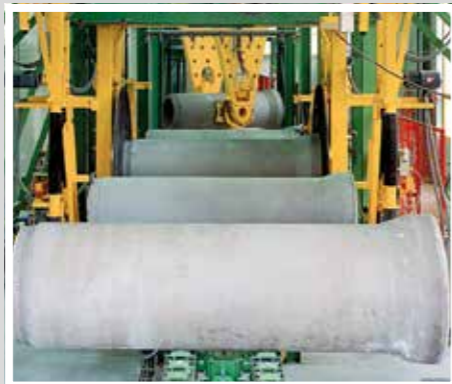
TTT Rohr-Prüfstrecke Ligne de contrôle
