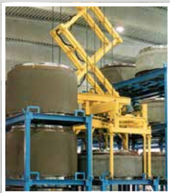
TTT Manipulación de pozos de inspección Manipulação do anel de inspeção e captura
