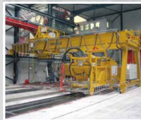
TTT Transporte de hormigón interno Transporte de betão interno
