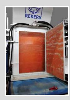
Großflächige Bunkerklappe zur einfachen Reinigung von Kern- und Vorsatzbunker.
