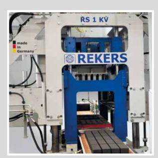
Höheneinstellung für Bunker und Füllwagen über einen beweglichen Rahmen mittels beider Formhubzylinder
