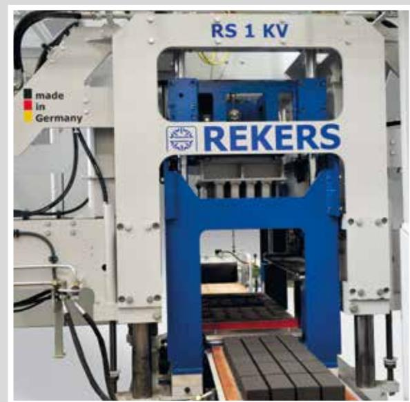
Ajuste de la altura de las tolvas y del carro de llenado a través de un bastidor móvil por los cilindros de elevación.
