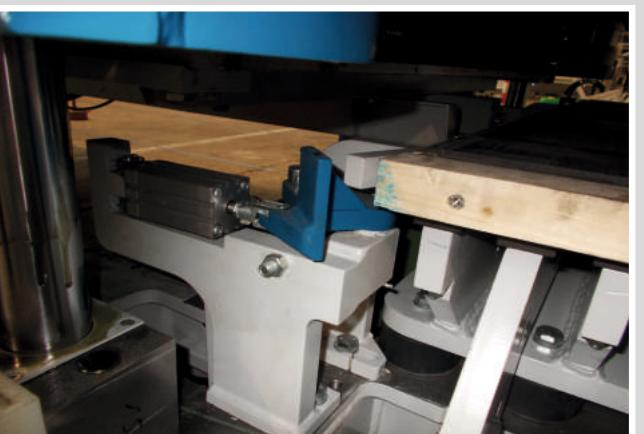
**El centrado de las bandejas en la área de la máquina de bloques**
