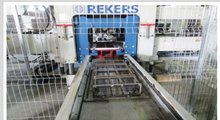
Inserción automática de armadura mediante chapa de extracción
