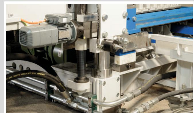
Ajuste de altura para las tolvas y carro de llenado a través de un bastidor móvil por medio de ambos cilindros de elevación del molde con sujeción opcional. Ajuste fino mediante husillo.
