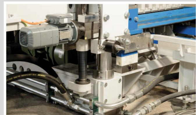
Höheneinstellung für Bunker und Füllwagen über einen beweglichen Rahmen mittels beider Formhubzylinder mit optionaler Verspannung. Feineinstellung über Spindelgetriebe.
