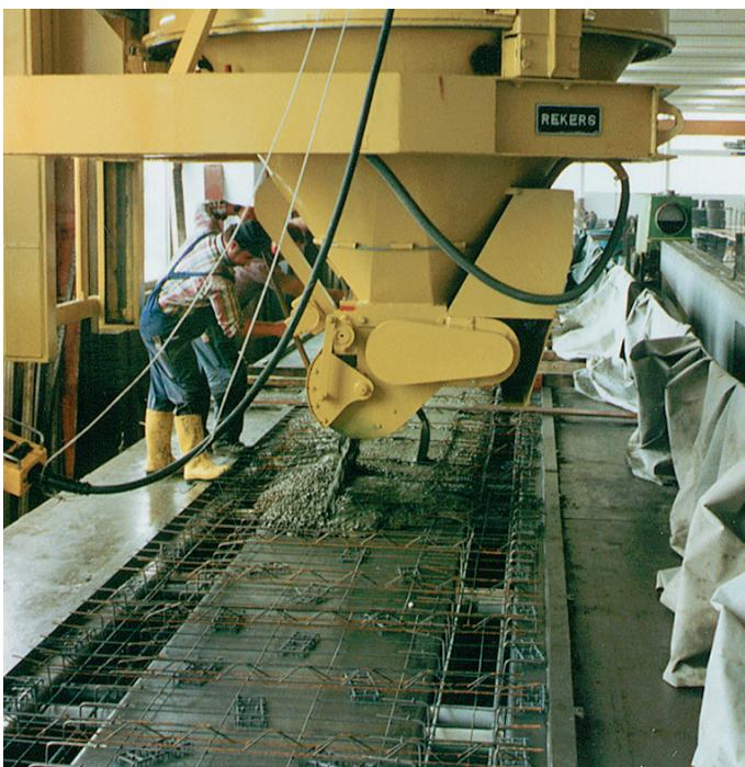
Wydawanie betonu z rozdzielacza może być realizowane w zależności od rodzaju betonu / materiału na różne sposoby. REKERS stosuje tutaj:
