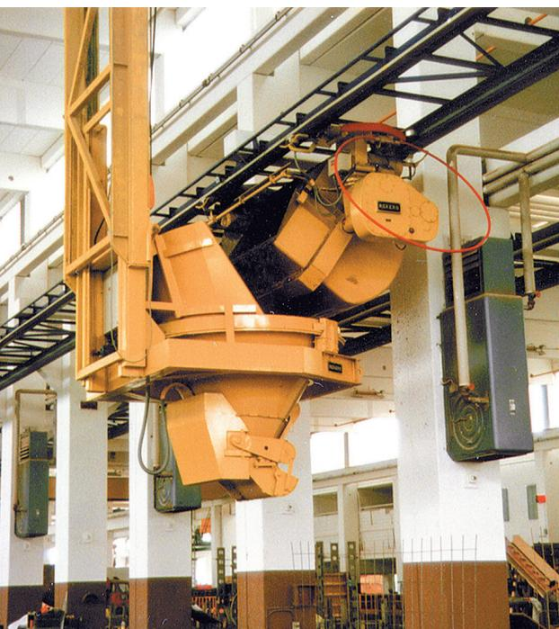
Der Austrag aus dem Betonverteiler kann je nach Betonart oder dem Material in unterschiedlicher Art ausgeführt werden. Bei Betonverteilern von Rekers kommen:
