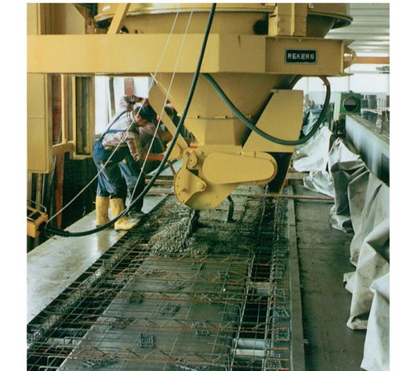
Выгрузка из бетонораспределителя может осуществляться различными способами в зависимости от типа бетона или материала. Вам предоставляются на выбор различные варианты оборудования:
