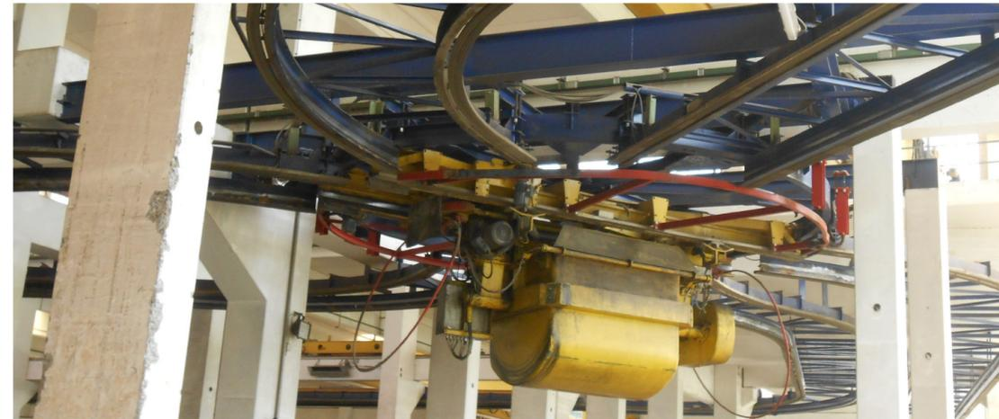
Aufgrund einer großen Variabilität unterschiedlicher Doppelfahrschienen mit verschiedenen Möglichkeiten von Kurven und Steigungen, lässt sich die Streckenführung in hohem Maße an örtliche Gebäudebedingungen anpassen. Je nach Bedarfsfall können Dreh-Kippkübelwagen oder Fischmaulkübelwagen mit Bodenentleerung mit einem Kübelinhalt von 500 l bis zu 4500 l eingesetzt werden (Sondergrößen und -ausführungen auf Anfrage).
