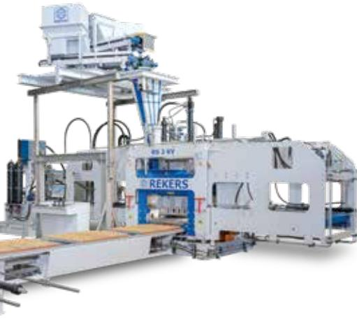
Wie die Steinformmaschine RS 1 sind auch die Steinformmaschinen RS 2 und RS 3 mit hydraulischem Antrieb der Füllwagen konzipiert. Jedoch nicht, wie bei traditionellen Maschinen, mittels Schwingen, sondern mittels direkt wirkender hydraulischer Zylinder. Alle Hauptbewegungen werden mittels Proportionalventiltechnik angesteuert und mithilfe absoluter Linearmesswertgeber überwacht.
