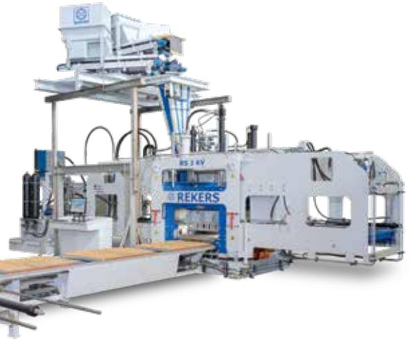
Wie die Steinformmaschine RS 1 sind auch die Steinformmaschinen RS 2 und RS 3 mit hydraulischem Antrieb der Füllwagen konzipiert. Jedoch nicht, wie bei traditionellen Maschinen, mittels Schwingen, sondern mittels direkt wirkender hydraulischer Zylinder. Alle Hauptbewegungen werden mittels Proportionalventiltechnik angesteuert und mithilfe absoluter Linearmesswertgeber überwacht.
