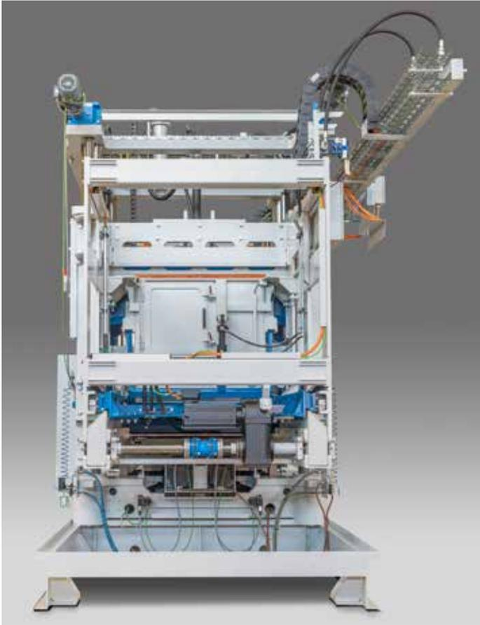
Die Steuerung der RS 4 basiert auf dem modernsten Stand der Siemens S7 TIA SPS und Siemens Simotion/Sinamics Steuerungstechnologie. Eine umfassende Visualisierung mit umfangreichen Möglichkeiten der Parametersetzung aller Prozessvariablen und tiefgreifende Diagnosefunktionen gehören ebenso zum REKERS Steuerungsstandard wie auch Formenverwaltung und Betriebsdatenerfassung sowie diverse Tools zur Prozessoptimierung.
