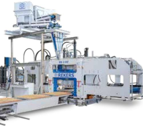
Assim como a máquina de fabricação de blocos RS 1, as máquinas de fabricação de blocos RS 2 e RS 3 também são projetadas com acionamento hidráulico para o carrinho de enchimento. Não, porém, como nas máquinas tradicionais, por meio de braços oscilantes, mas por meio de cilindros hidráulicos de ação direta. Todos os movimentos principais são controlados pela tecnologia de válvulas proporcionais e monitorados por sensores lineares absolutos.
