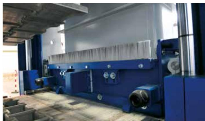
Sello de limpieza transversal para productos con perfilado transversal de la superficie
