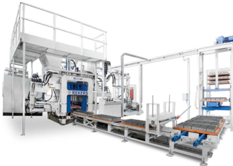
El RS 1 está equipado con un carro de llenado accionado directamente por cilindros hidráulicos sin balancines ni barras de acoplamiento. Todos los movimientos principales se controlan mediante tecnología de válvulas proporcionales y se supervisan mediante sensores lineales absolutos.
