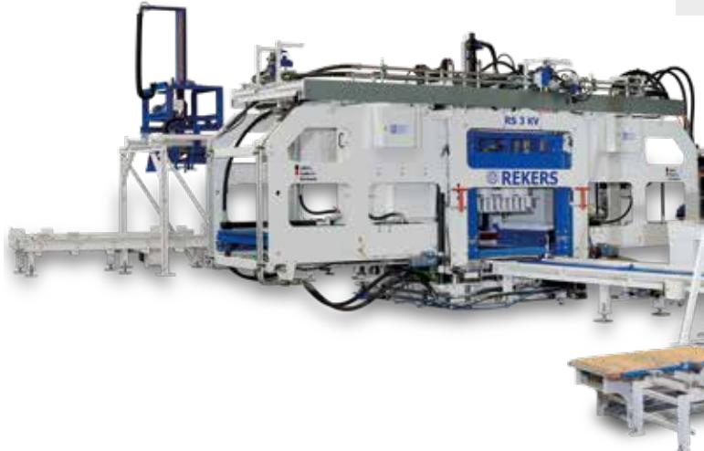
Al igual que la máquina para fabricar bloques RS 1, las máquinas para fabricar bloques RS 2 y RS 3 también están diseñadas con un accionamiento hidráulico para el carro de llenado. No, sin embargo, como en las máquinas tradicionales, mediante brazos oscilantes, sino mediante cilindros hidráulicos de acción directa. Todos los movimientos principales se controlan mediante tecnología de válvulas proporcionales y se supervisan mediante sensores lineales absolutos.
