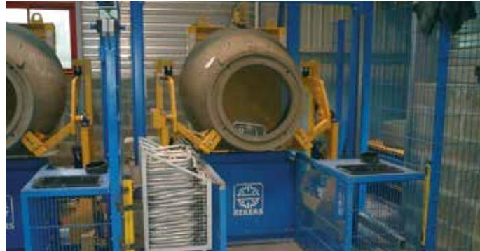
Pour la manipulation des rehausses et des tuyaux de regard, REKERS peut offrir la bonne solution et la bonne partie du système pour chaque processus individuel comparable à la manipulation des tuyaux.
