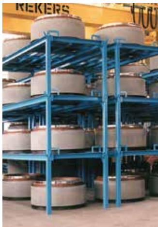
Als eine Besonderheit für Schachtringe und Schachtrohre kann auch ein vollautomatischer Manipulator angeboten werden, der u.a. Stapelpaletten handelt, auf denen die grünen Schachtringe und Schachtrohre zur Aushärtung bereitgestellt werden. Dieses ermöglicht eine optimierte Ausnutzung der Raumhöhe und ein kompaktes Layout des Aushärtebereiches.
