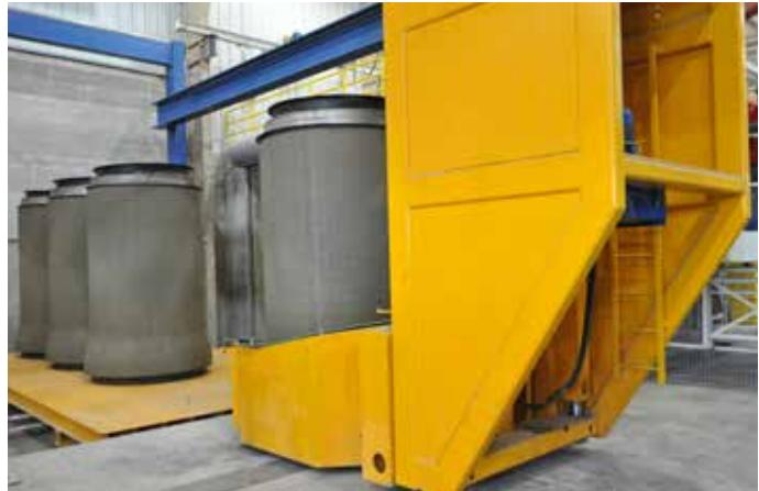
Pour les concepts de système avec des conditions de durcissement contrôlées (température et humidité), REKERS utilise un système de circulation de palettes pour un durcissement accéléré.
