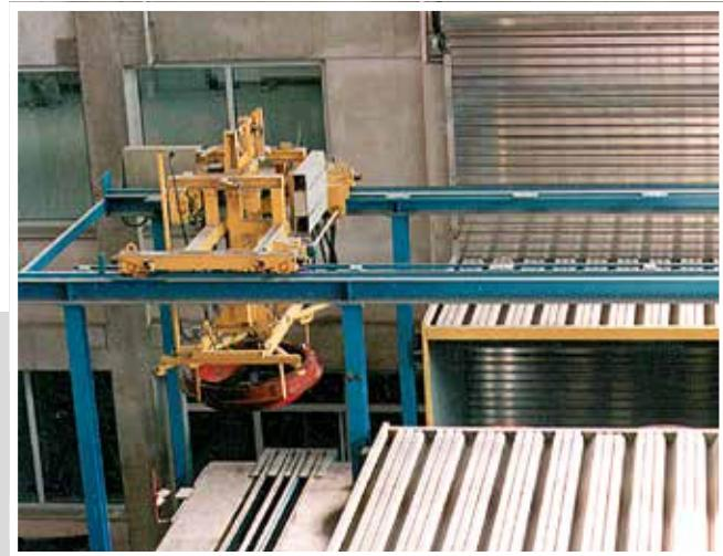
Nach vorgegebener Verweilzeit (ca. 1,5 Std.) werden die Stützhauben automatisch gezogen und zur Nachbearbeitungsbühne zurückgeführt.
