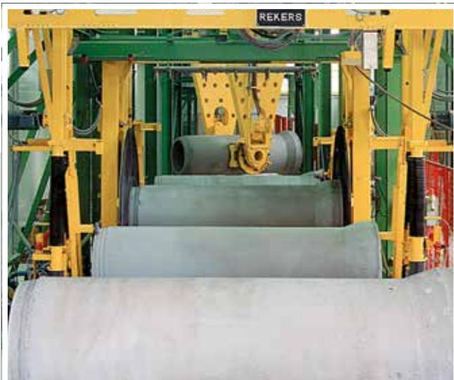
Die REKERS Rohr-Nachbehandlung bietet einen vollautomatischen Ablauf von Entgratung und Qualitätskontrolle entsprechend den FBS-Qualitätsrichtlinien. Geeignet ist dieses System sowohl als Bestandteil einer vollautomatischen Rohrtransportanlage als auch für manuelle Aufgabe mittels Stapler.
