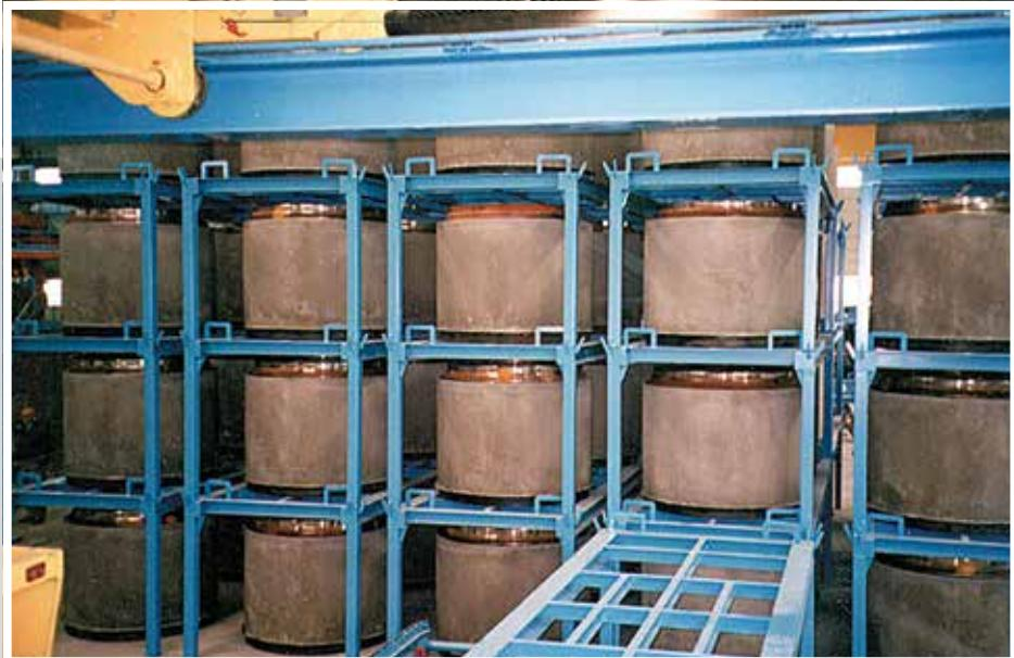
Lagerung von Schachtprodukten der NW 800-1500 mm, Höhe bis 2000 mm in Stapelpaletten. Gewährleistung optimaler Flächenausnutzung.
