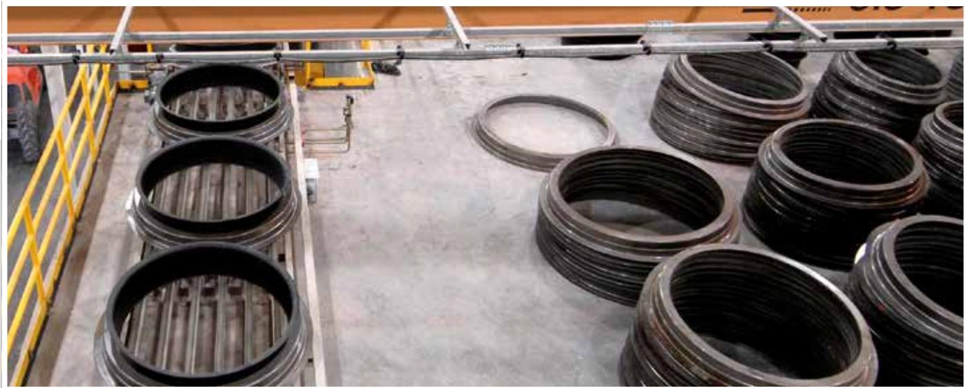
Die aufwendige Verwaltung der Muffen mit Stapler, das Reinigen und Einlegen der Muffen von Hand wird übernommen durch das REKERS-Muffenhandlingssystem.
