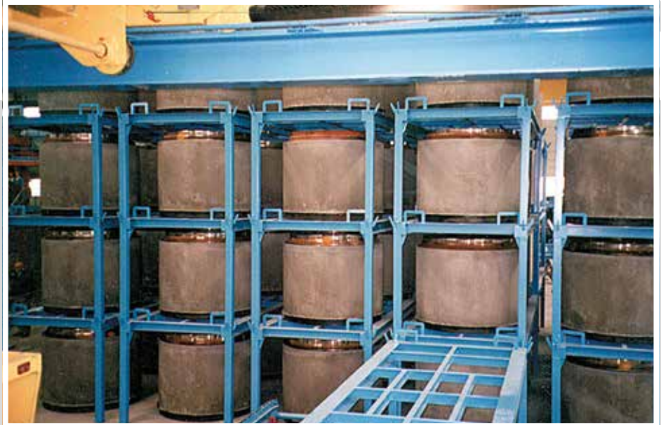
Складирование изделий шахт, тип NW 800-1500 мм, высотой до 2000 мм на специальных поддонах. Гарантирует оптимальное использование складского помещения.
