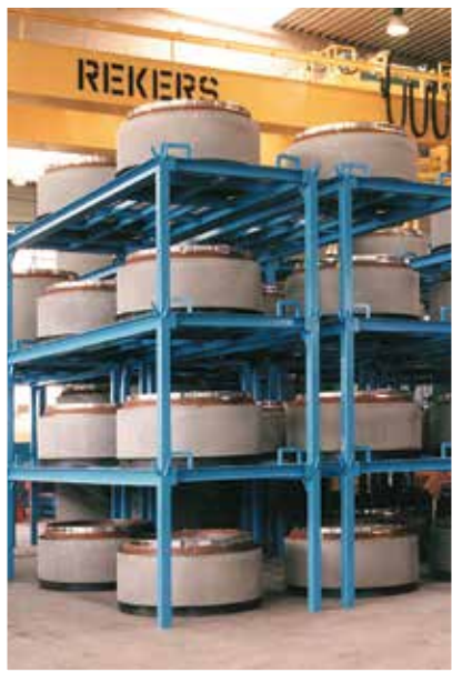
Lagerung von Schachtprodukten der NW 800-1500 mm, Höhe bis 2000 mm in Stapelpaletten. Gewährleistung optimaler Flächenausnutzung
