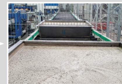
Transport de la chambre de séchage vers la station de pré-écrasement
