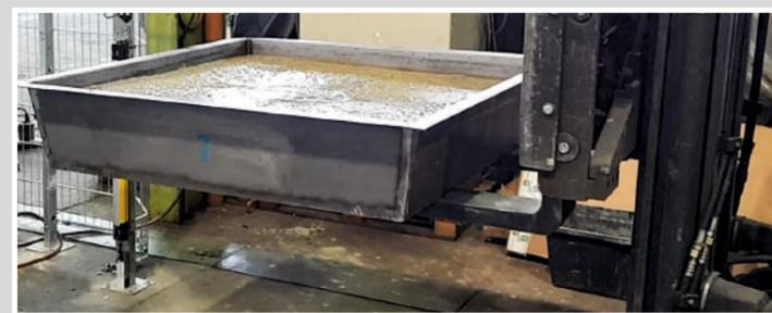
Transport vers la chambre de séchage; Stockage à température ambiante; Durée de stockage 16 – 24 heures
