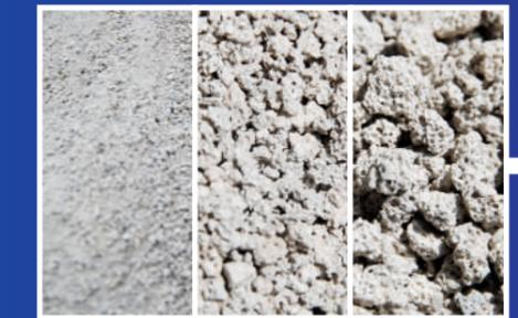
Criblage en différentes granulométries: 0-2, 2-6, 6-12 mm
