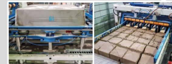
Démoulage des bacs et découpe des blocs curés en cubes
