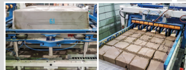
Rozszalowanie wanny i krojenie stwardniałych bloków w kostki
