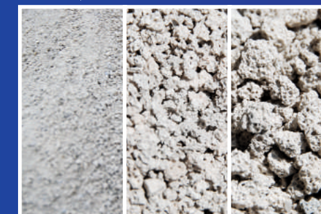
Frakcjonowanie na sitach w granulacji: 0-2, 2-6, 6-12 mm
