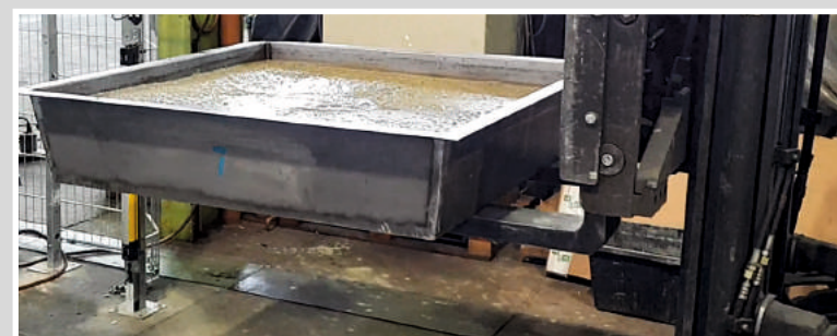
Transport do komór suszarni. Składowanie w temperaturze pokojowej, czas sezonowania 16 – 24 godzin
