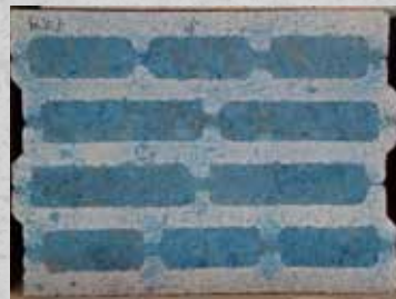
HBL 25 mit Steinwoll-schaummasse HBL 25 avec masse de laine de roche
