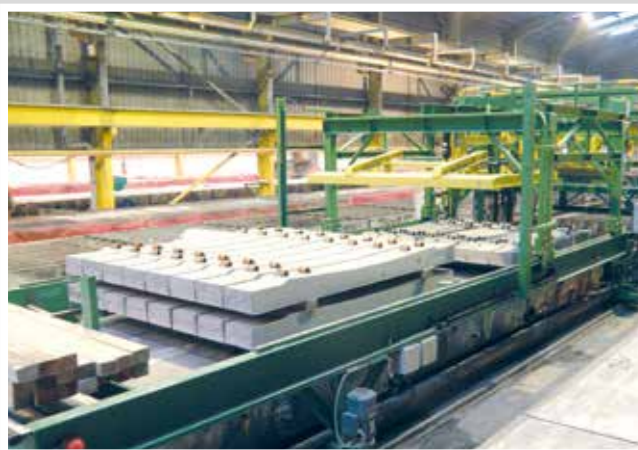
Spannbett zur Herstellung von vorgespannten Weichen- und Streckenschwellen.
