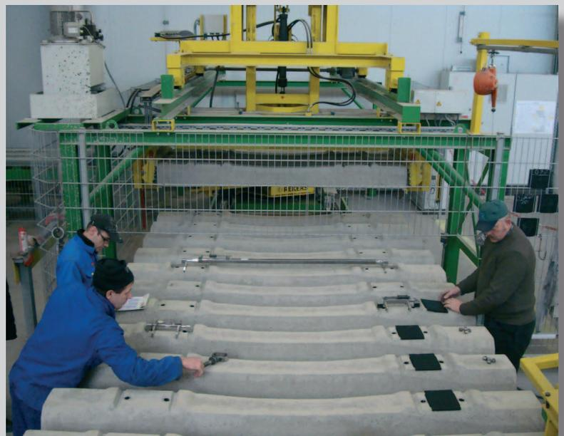
Effizienz und Zuverlässigkeit prägen die Kreislaufanlagen und Handlingsgeräte von REKERS. Förderstrecken, Manipulatoren und schienengebundene Transportfahrzeuge sorgen für einen behutsamen Transport der schweren Bahnschwellen. Die intuitiv bedienbare REKERS Steuerung beinhaltet auch die vollautomatische Verwaltung der Aushärtekammer.
