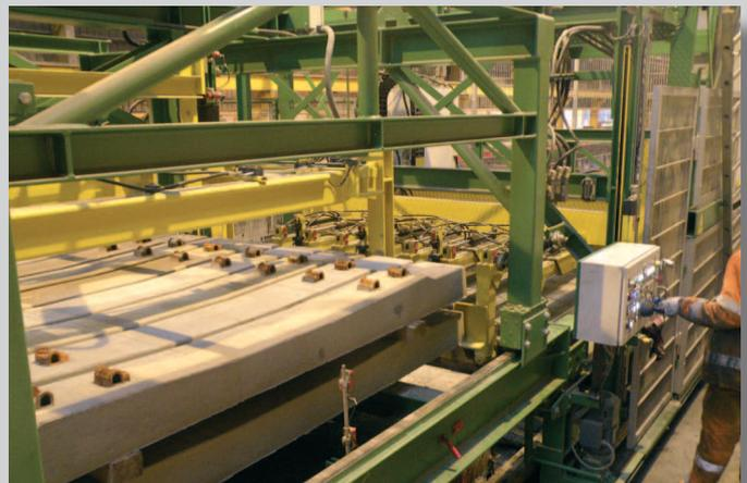
Spannbett zur Herstellung von vorgespannten Weichen- und Streckenschwellen.
