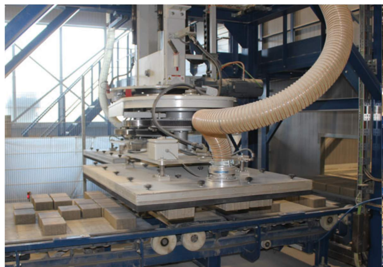
Nach Aufnahme der ausgewählten Produkte mit den Vakuum-Greifern erfolgt über die Mittelachse der Rahmenkonstruktion eine 180° Wende der zwei Greifer.
