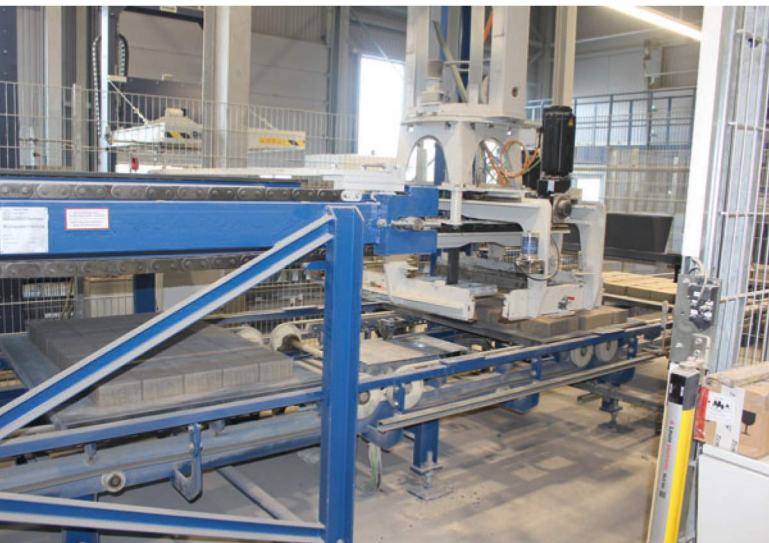
Vierseitig betätigter, elektro-mechanische Steinlagen-umsetzer
