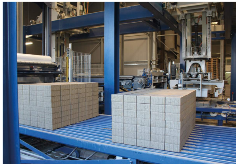
Die Auflageprofile des Paketförderers sind so angeordnet, dass Steine mit einer minimalen Breite von 100 mm angehoben und transportiert werden können.
