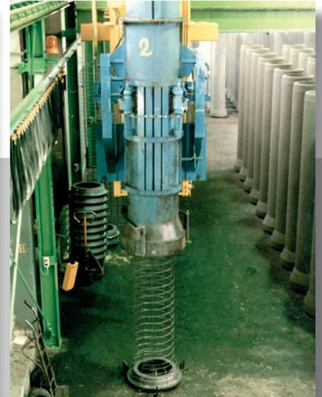
Zwei Manipulatoren arbeiten ausweichend auf einer Kranbahn. Vollautom. Ablauf von Untermuffen und Bewehrungsaufnahme. Untermuffenverwaltung und Rohrprüfung
