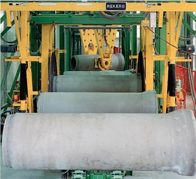
Die REKERS Rohr-Nachbehandlung bietet einen vollautomatischen Ablauf von Entgratung und Qualitätskontrolle entsprechend den FBS-Qualitätsrichtlinien. Geeignet ist dieses System sowohl als Bestandteil einer vollautomatischen Rohrtransportanlage als auch für manuelle Aufnahme mittels Stapler.
