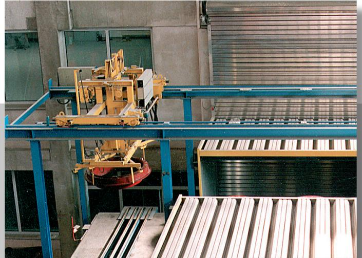
Nach vorgegebener Verweilzeit (ca. 1,5 Std.) werden die Stützhauben automatisch gezogen und zur Nachbearbeitungsbühne zurückgeführt.
