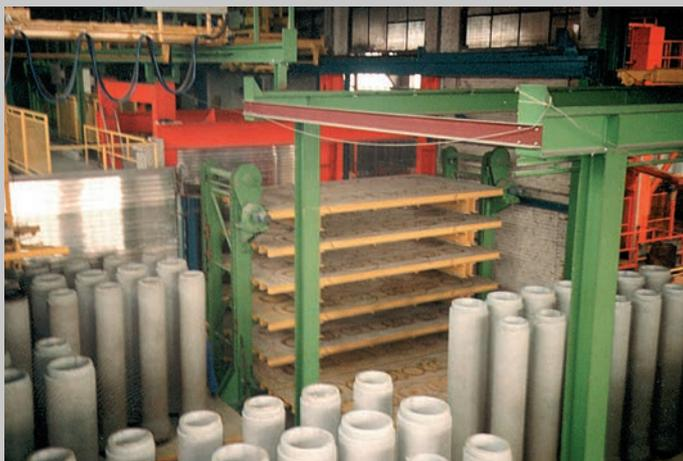
Palettenmagazin zur Pufferung von Transportpaletten. Um ein taktzeitunabhängiges Ein- und Auslagern zu gewährleisten, können Transportpaletten dem Umlauf entnommen bzw. zugefügt werden.
