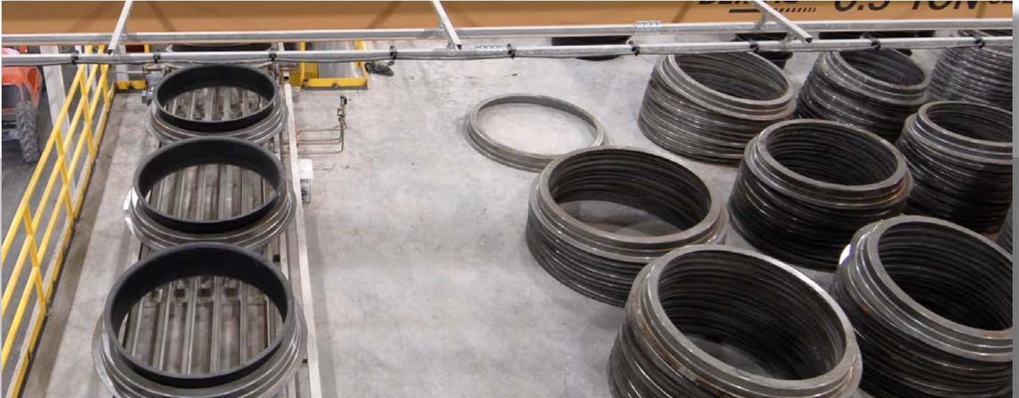
Die aufwendige Verwaltung der Muffen mit Stapler, das Reinigen und Einlegen der Muffen von Hand wird übernommen durch das REKERS-Muffenhandlungssystem.
